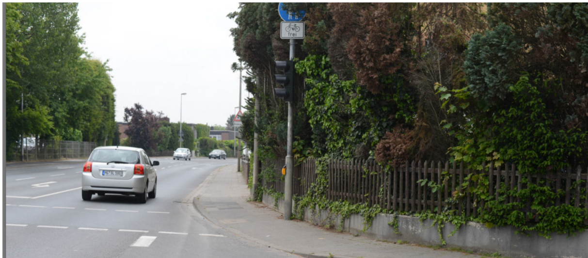
Abbildung 60 und Abbildung 61: Im Bereich des Knotenpunktes Lohfeldstraße / Ulmenweg sind die für den Radverkehr freigegebenen Gehwege ca. 1,50 m breit. Dieses Maß ist unzureichend
