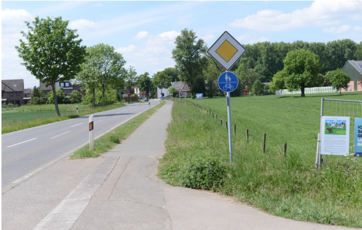
Abbildung 76: Mit einer Breite von < 2,00\text{ m} entspricht der Weg nicht den Richtlinien
